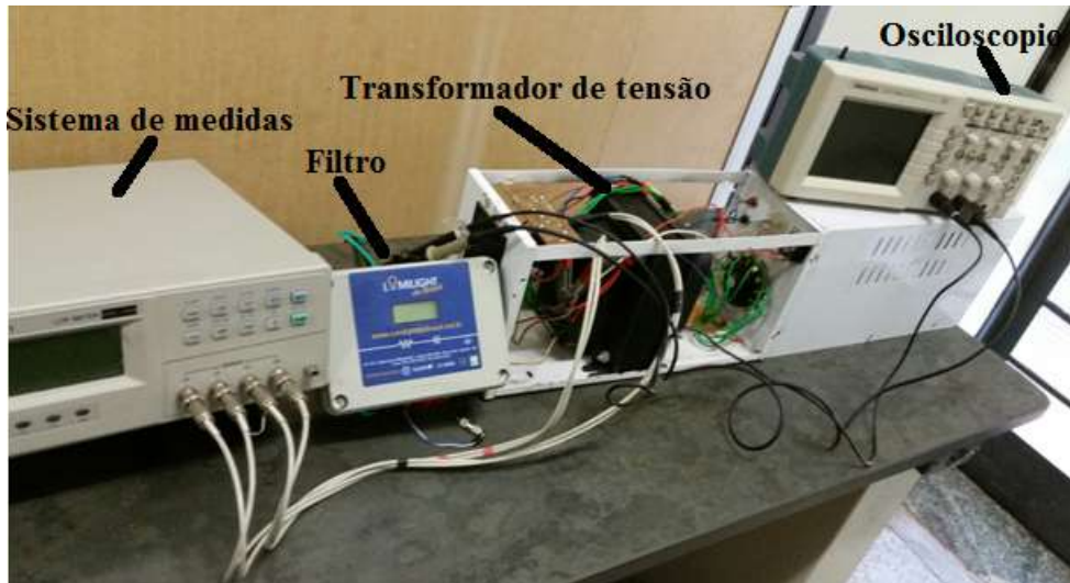
Figura 3- Arranjo experimental para medir o efeito do surto no Filtro.
